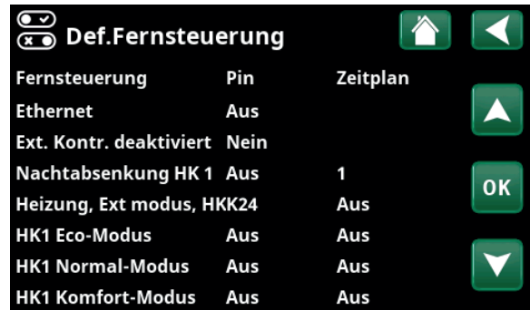
Ausschnitt aus dem Menü „Fachmann/Definieren/Fernsteuerung“. Hier werden „Eingang“ und „Zeitplan“ festgelegt.
