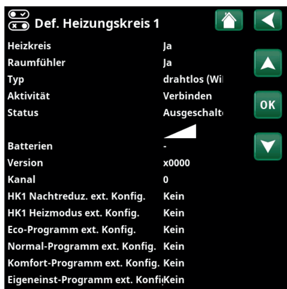
Menü: „Fachmann/Definieren/Heizkreis/Heizkreis 1“. Drahtloser Raumfühler ausgewählt.
