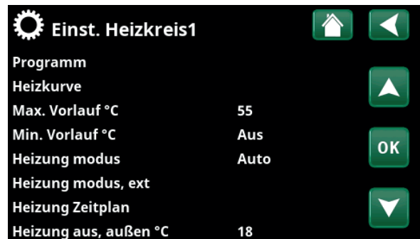
Ausschnitt aus dem Menü „Fachmann/Einstellungen/Heizkreis/Heizkreis 1“.
