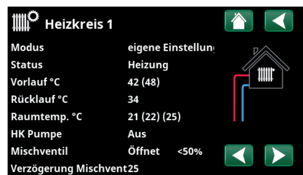
Das Menü zeigt detaillierte Betriebsdaten des ausgewählten Heizkreises an. Zur Anzeige festgelegter Heizkreise die Pfeiltasten anklicken oder wischen.
