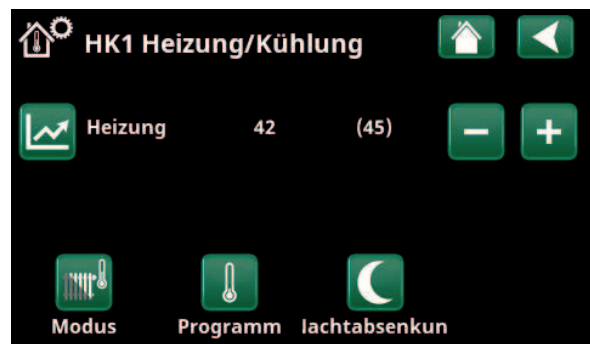
Menü „Fachmann/Setup/Heizkreis/Heizkreis 1“. Die Heizkreis hat keine Raumfühler. Der Sollwert (Vorlauftemperatur 45 °C) ist in Klammern angegeben, die aktuelle Vorlauftemperatur 42 °C ist links vom Sollwert angegeben.
