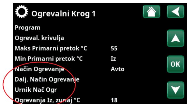
Del menija »Instalater/Nastavitve/Ogrevalni krog/Ogrevalni 1«
