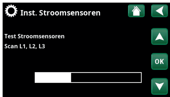
Menu: "Installateur/Instellingen/Stroomsensoren /Auto config. stroomsensor".
