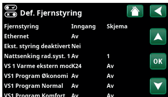
Del av menyen «Avansert/Definere/Fjernstyring».
