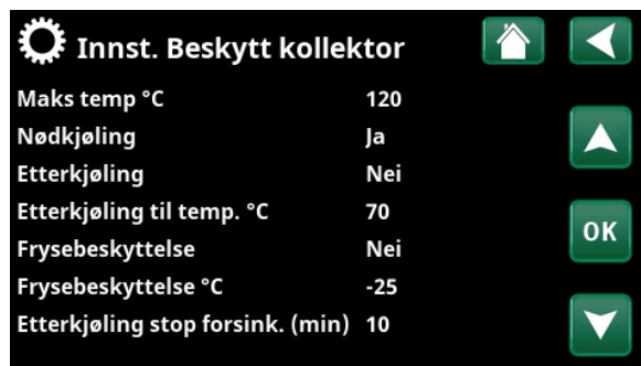
Meny «Avansert/Innstillinger/Solpaneler/Beskyttelse kollektor».
