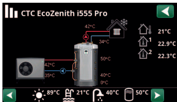
Hovedmenysiden for «Driftsinfo» med luft/vann-varmepumpe CTC EcoAir tilkoblet. Når pumpene er i drift, roterer også pumpesymbolene i bildet.
