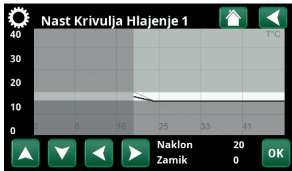
Meni: »Instalater/Nastavitve/Hlajenje/Krivulja Hlajenje/Nast. Krivulja Hlajenje«.
