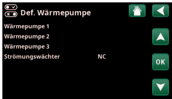
Beispiel eines Systems mit drei Wärmepumpen. Menü „Erweitert/Systemdefinition/Wärmepumpe“.
