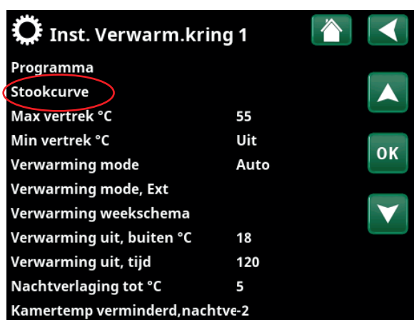
Onderdeel van het menu: "Installateur/Instellingen/Verwarmingskring/Verwarmingskring 1".
