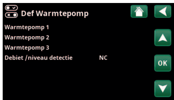
Menu: "Installateur/Definieer/Warmtepomp". Selecteer een warmtepomp en druk op "OK" om naar de instellingen te gaan.
