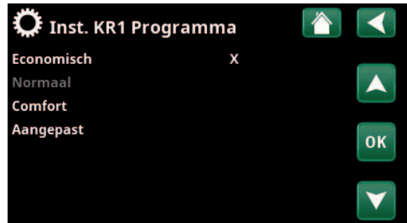
Menu "Installateur/Instellingen/Verwarmingskring/Verwarmingskring 1/Programma".
