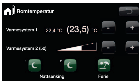
Eksempelet over viser drift med to varmesystemer. Varmesystem 1 med romføler og varmesystem 2 uten romføler.
