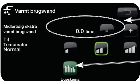
Produktet begynder at producere ekstra varmt vand.
