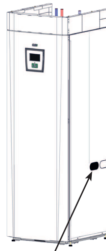
Raccordement côté droit (Utilisez la sortie avant)
