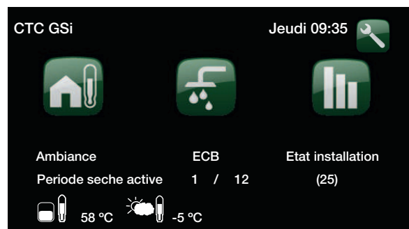
Exemple de données opérationnelles pour Mode 2, Jour 1 de 12 avec valeur de consigne actuelle (25) °C.
