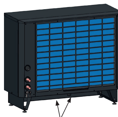
Kondenstråg och kondensvattenrör.
