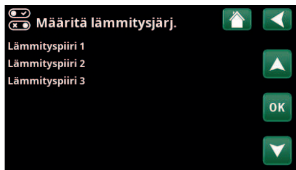
Valikko "Edistyneempi / Määrittele / Piiri". Valitse lämmityspiiri ja tee asetukset painamalla "OK".
