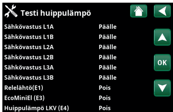
Valikko "Edistyneempi / Huolto / Toimintatesti / Huippulämpö".
