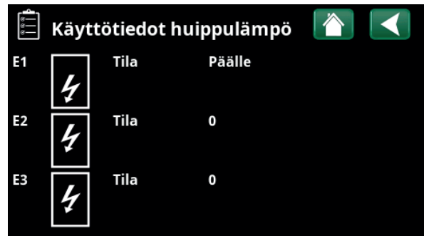
Valikko näytetään, kun napsautetaan huippulämmön kuvaketta alimpana Käyttötiedoissa/aloitussivulla. Napsauta huippulämpöä (E1-E3) nähdäksesi yksityiskohtaiset "Käyttötiedot".
