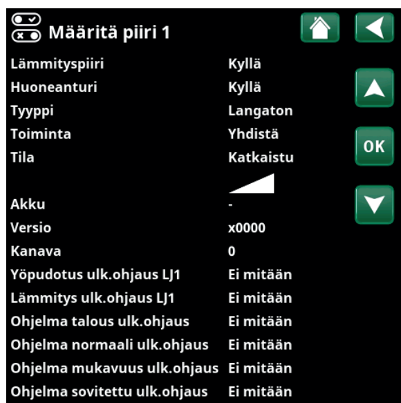
Valikko "Edistyneempi / Määrittele / Piiri / Piiri 1". Langaton huoneanturi on valittu.
