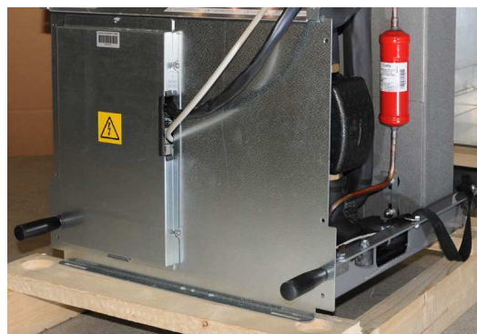
6. Lyft in kylmodulen i produkten med hjälp av bärhandtag och bärremmar. Lossa bärhandtag, samt återmontera elkabelkontakt, slangar och skruvar.
