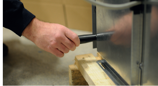
2. Kiinnitä kantokahvat (2kpl) kylmämoduulin alalaitaan.
