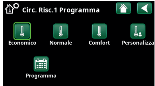
Menu "Circ. Risc. 1 Riscald./Raffresc. / Circ. Risc. 1 Programma" per il quale è stato attivato il programma "Economico".
