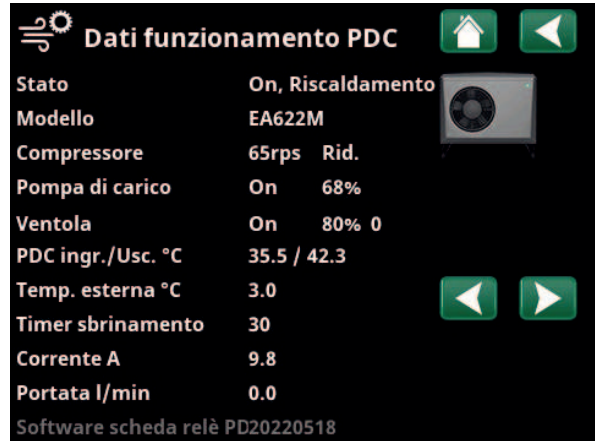
Menù: "Dati funzionamento, Pompa di calore".
