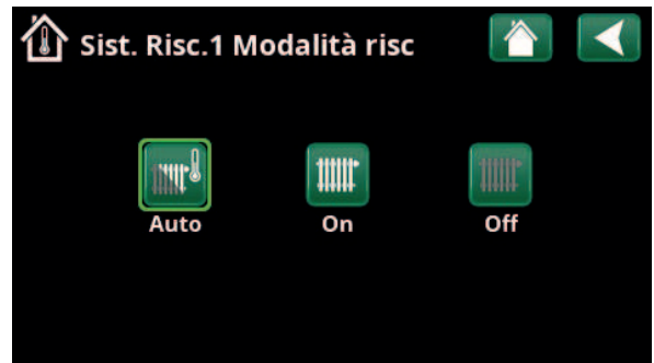
Menu "Circ. Risc. 1 Riscald./Raffresc./Circ. Risc. 1 Modalità riscaldamento" per il quale è stato attivato il modo "Auto".
