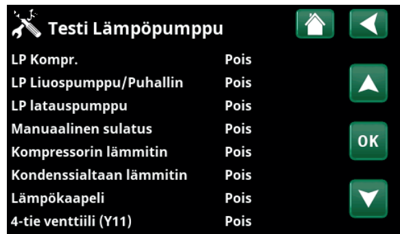
Valikko "Edistyneempi / Huolto / Testi / Lämpöpumppu".
