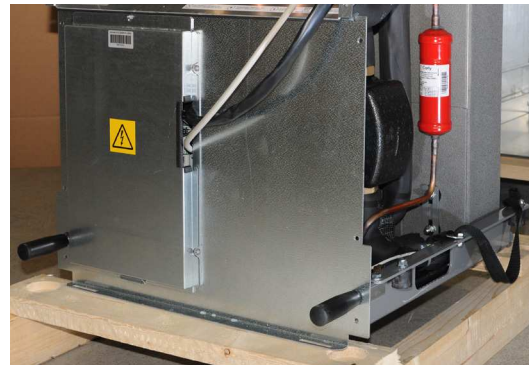
6. Asenna kylmämoduuli takaisin kahvojen ja nostoremmin avulla, irrota kahvat ja remmi, kiinnitä ruuvit, sähköpistokkeet ja letkut.
