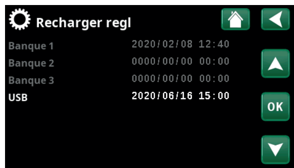
Menu : «Installateur/Réglages/Recharger regl».
