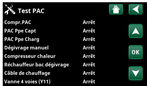
Menu : « Installateur/Service/Test Relais/Pompe A chaleur ».
