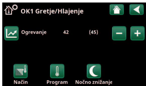
Meni »Instalater/Določí/Ogrevalni krog/Ogrevalni krog 1«. Ogrevalni krog nima sobnih senzorjev. Nastavljena vrednost (temperatura primarnega pretoka znaša 45\text{ }^{\circ}\text{C} ) je prikazana v oklepaju, trenutna temperatura primarnega pretoka 42\text{ }^{\circ}\text{C} je prikazana levo od nastavljene vrednosti.
