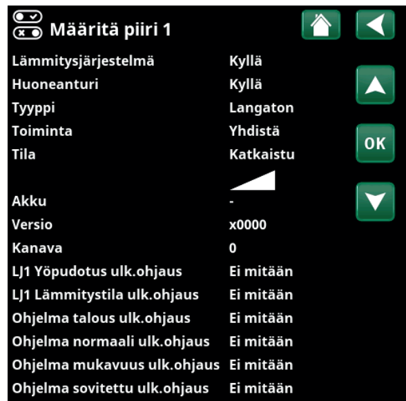
Valikko "Edistyneempi/Määrittele/Lämmitysjärjestelmä/LJ1". Langaton huoneanturi on valittu.
